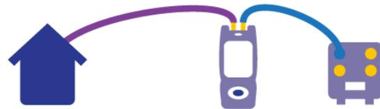
Um den korrekten Anschluss des Testers zu gewährleisten hat VIAVI das exklusive DuoPort-Design mit PosiScan entwickelt. Ein Port prüft die vom Haus ausgehende Störeinstrahlung, während der andere Port gleichzeitig die Downstream-Dienste testet. PosiScan erhöht die Konformität, indem diese Funktion kontrolliert, ob der Techniker mit der korrekten Wohnung verbunden ist.
